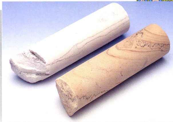
Fig. 15. To stykker skrivekridt fra et olie-felt i Nordsoen. I den lyse kerne er pore-rummene fyldt med vand, og bjergarten har samme gråhvide farve som vådt kridt fra Møns Klint. Det brune stykke kerne indeholder foruden vand også olie, og det er fra denne bjergart olien tages op.
