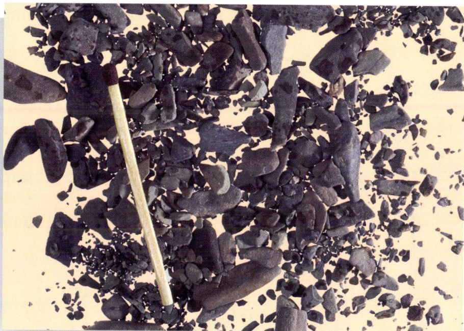
Fig. 22. Borepåner eller cuttings. Ved borearbejdet mejsles små stykker af bjergarterne løs, borepåner eller cuttings. Stykkerne føres med boremudderet op til jordoverfladen. Cuttings vaskes ud af boremudderet, og de små bjergartsstykker giver geologerne de første oplysninger om, hvilke formationer der børes i. Som målestok er benyttet en tændstik.
