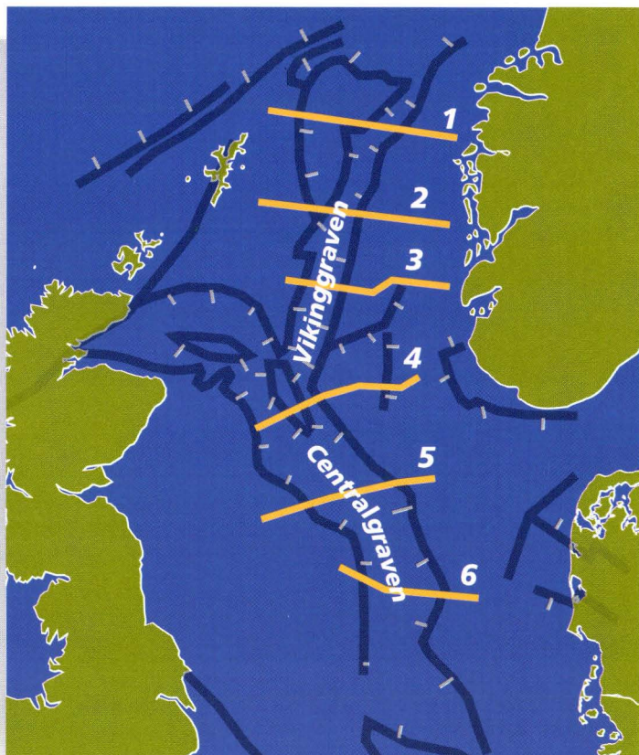
Fig. 4. Kortet viser de store strukturer i undergrunden under Nordsøen. Forkastningszoner adskiller områder, der er hævet fra områder, der er sunket. På grund af senere erosion og pålejring kan man ikke se højdeforskelle mellem blokkene på den nuværende havbund. De gule streger refererer til profilerne på fig. 5 side 12.
